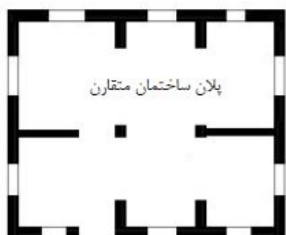
شکل - افزایش مقاومت برشی و انسجام ساختمان
