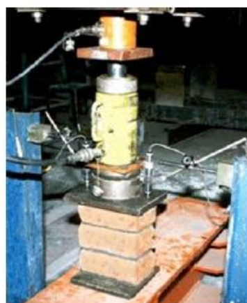
شکل - نحوه انجام آزمایش منشور آجری در آزمایشگاه
